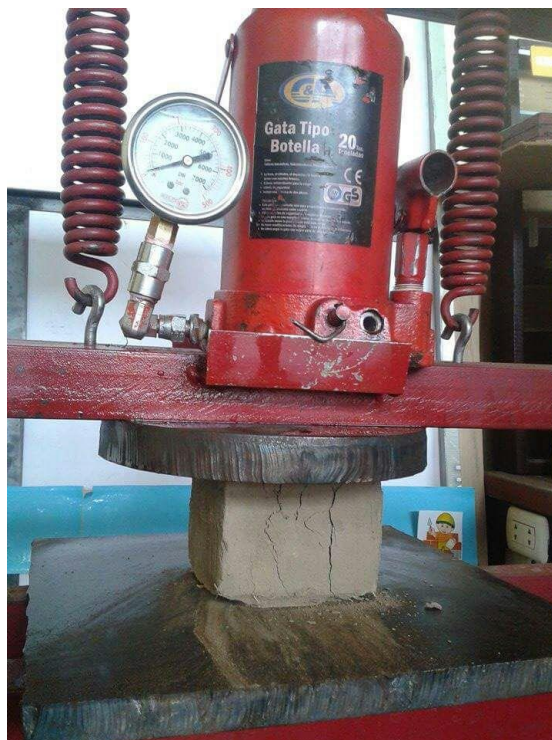
Figura 02: Ensayo de compresión a las probetas
