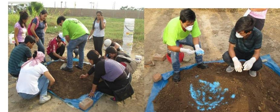
**Figura 1 y 2:** Preparación del suelo antes de ser contaminado. Enmienda del suelo con  $\text{CuSO}_4$
