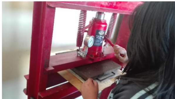
Figura 01: Prensado de las probetas
