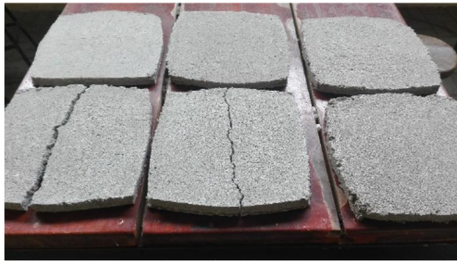
Figura 04: Paneles sometidos a flexión
