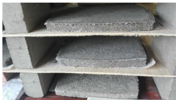
Figura 02: Secado de las probetas
