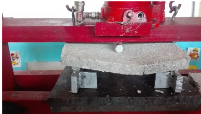
Figura 03: Ensayo de flexión
