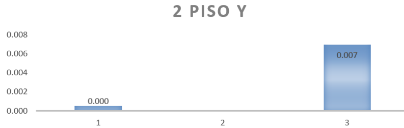
Figura 10: Distorsión del eje Y en segundo piso.
