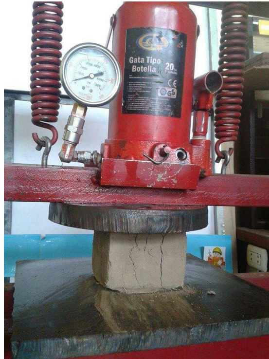
Figura 02: Ensayo de compresión a las probetas
